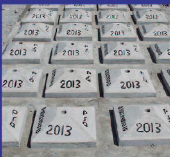
BLOQUES PARA RETENIDAS 0.40 X 0.40 X 0.15
